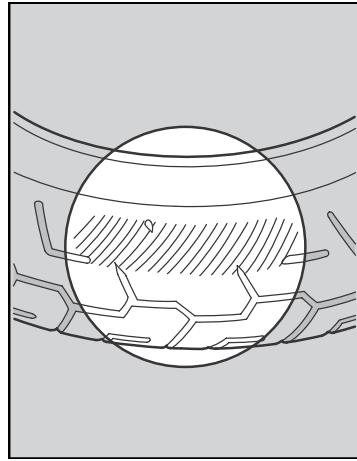
タイヤの接地面が異状に摩耗していないかを点検します。
