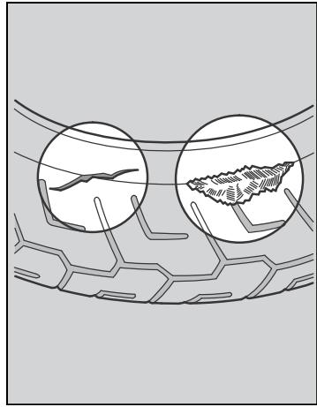
タイヤの全周に、亀裂や損傷、ひび割れおよび鉄石、その他の異物が刺さつたり、かみ込んだりしているいかを点検します。道路の縁石などにタイヤ側面を接触させたときは、必ず点検してください。
